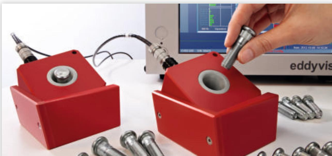
Ukázka možnosti manuálního zkoušení v laboratoři nebo při zkoušení malých sérií s kruhovými cívками.
