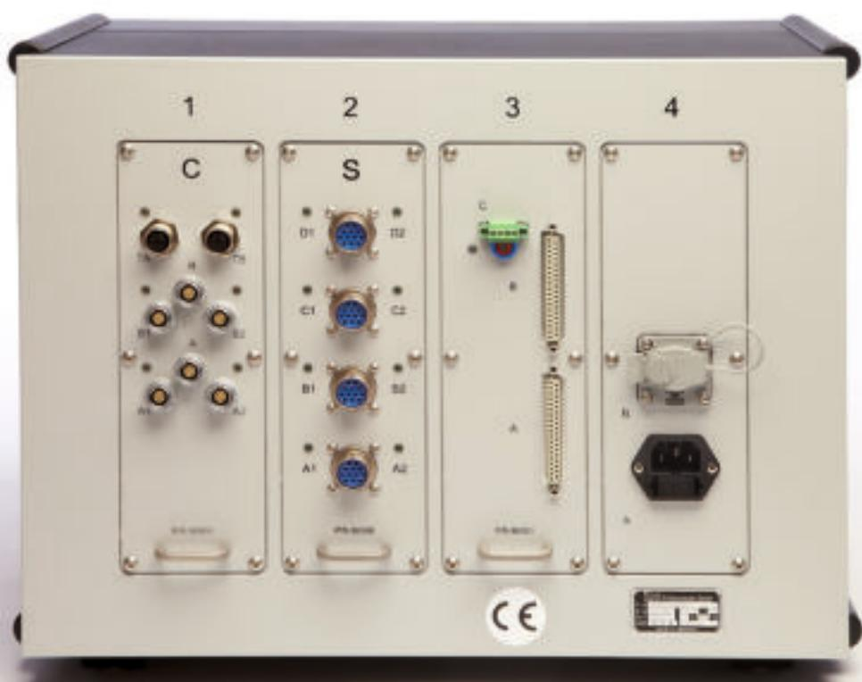
Zadní strana přístroje eddyvisor vybavená (zleva) modulem zkoušení prasklin 4-kanálový, modulem pro zkoušení struktury 8-kanálovým, IO-modulem, modulem pro připojení k síti.
