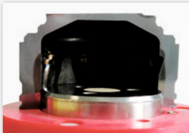
Cívka pro kontrolu vnitřní tvrzené zóny upravená pro ukotvení v přesné pozici vnitřního tvaru dílu.
