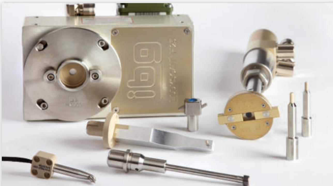
Vysoká přesnost měření a senzitivita sondy různých rozměrů pro zkoušení prasklin a brusných popálenin. Vzadu vlevo eddyscan H-rotační hlava pro zkoušení povrchu delších dílů např. tyčí, vzadu vpravo eddyscan F-rotační hlava pro zkoušení vnitřních ploch a otvorů.
