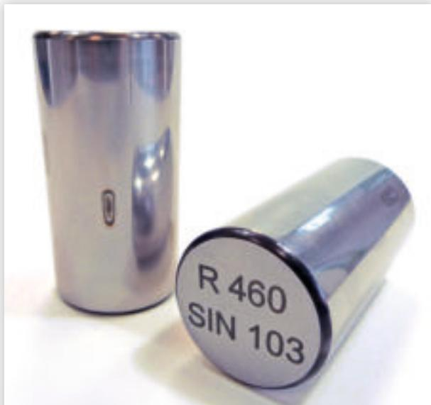
ibg nabízí výrobu tohoto NOK vzorku pomocí laseru. Brusné popáleniny: změna intenzity zbytkového napětí (obrázek úplně vlevo) a počáteční změna události (vlevo).
