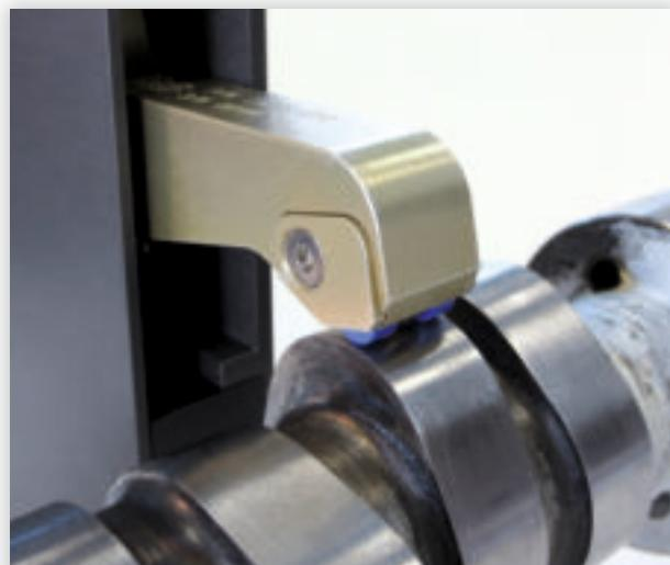
Box na zkoušení povrchu excentrických dílů jako např. prasklin a brusných popálenin; pokrývá velký rozsah průměrů; až do 300 rpm (záleží na geometrii dílu), keramická krytka pro větší ochranu při měření. Řešení pro zkoušení struktury na vačkové hřídeli možno připravit na zakázku.
