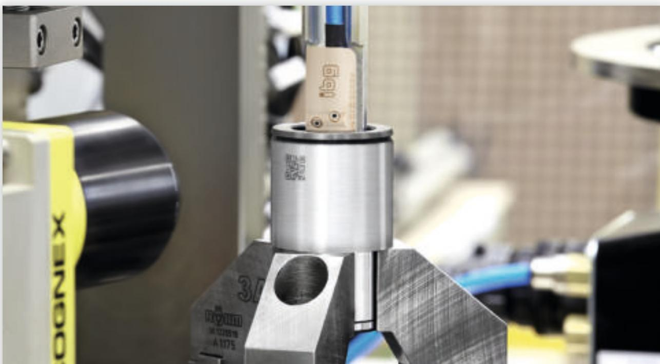
Matici řízení na plnoautomatickém ibg zařízení. Detekci prasklin a brusných popálenin je možno zařadit přímo do výrobního procesu k posuvnému pásu. Pro definici typového dílu používáme kamerový systém a QR kódy.
