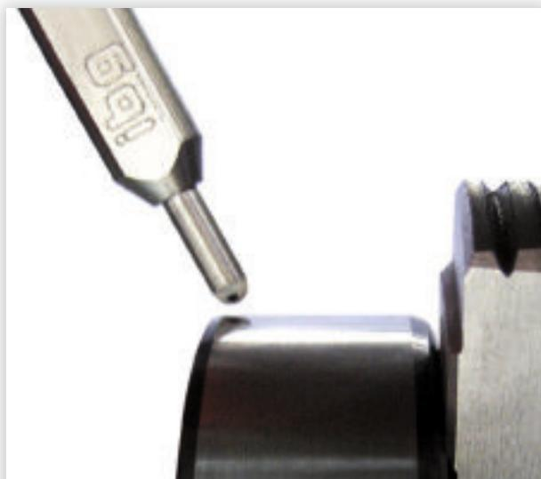
Zkoušení prasklin a brusných popálenin se sférickou-X-Typ-diferenční sondou je speciální provedení ibg na ložiskovém kroužku.
