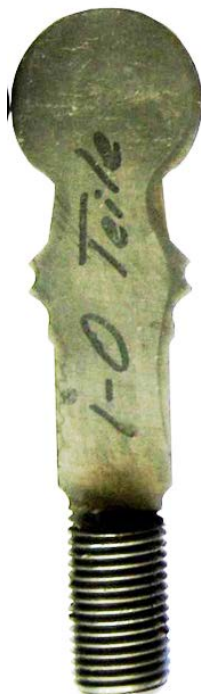
Härteprofil eines geschnittenen und geätzten i.O.-Teils
